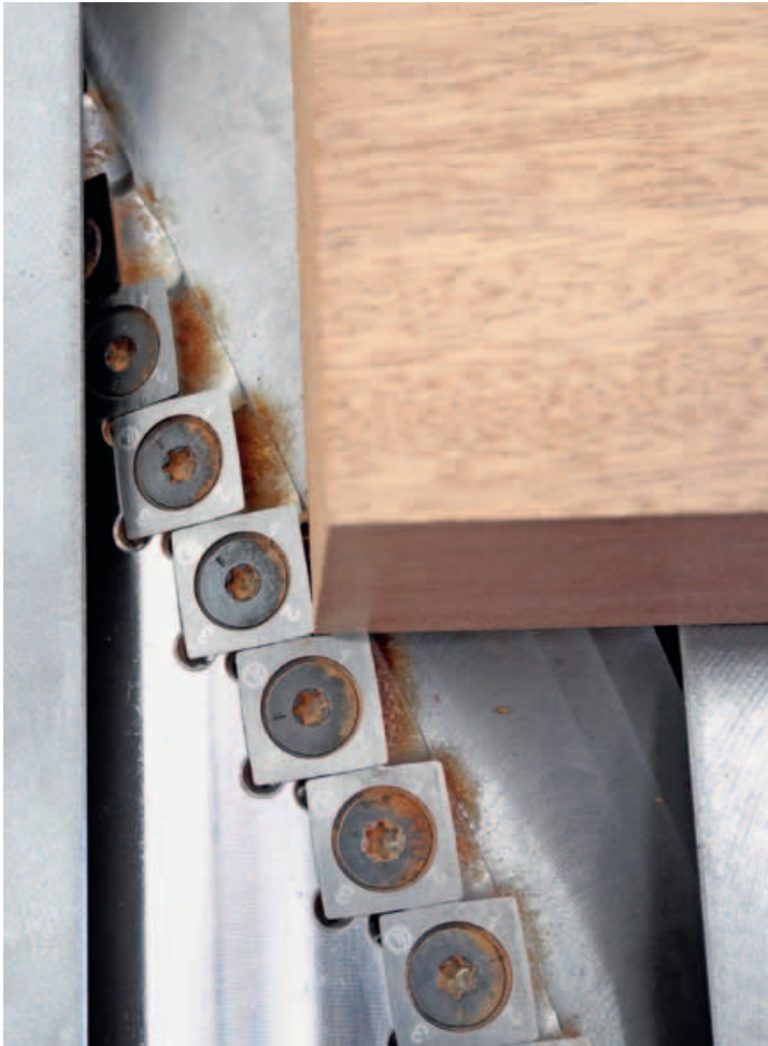
/ Das Testteam spricht von einer faszinierenden Oberflächenqualität. Grund dafür ist auch der auf dem Foto gut zu erkennende Achswinkel der HM-Wendeplatten, der für einen ziehenden Schnitt und tolle Hobelergebnisse sorgt.
