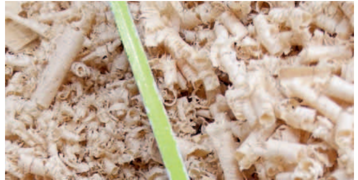
/ Interessant: Die Späne der Silent-Power-Welle (l.) sind deutlich kleiner als die der Streifenmesserwelle. Das hat zwei positive Nebeneffekte – das Spänevolumen ist deutlich geringer und die Absaugung funktioniert spürbar besser.
