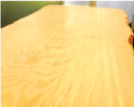
/ Ein Kiefern Brett, 370 mm breit, war für die Silent-Power-Welle ein Kinderspiel. Probleme bei Spanabnahmen zwischen 8 und 2 mm gab es nicht.
