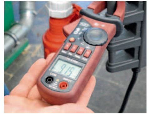
/ Messung der Stromaufnahme: Die Unterschiede beider Hobelwellen sind marginal und somit unbedeutend für einen potentiellen Kauf.
