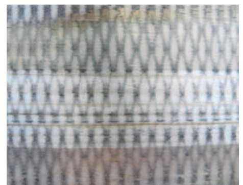
/ Ein schönes (präpariertes) Muster, erzeugt von den vielen kleinen Wendepplatten auf der Spiralhobelmesserwelle. Mit bloßem Auge ist dies nicht erkennbar.
